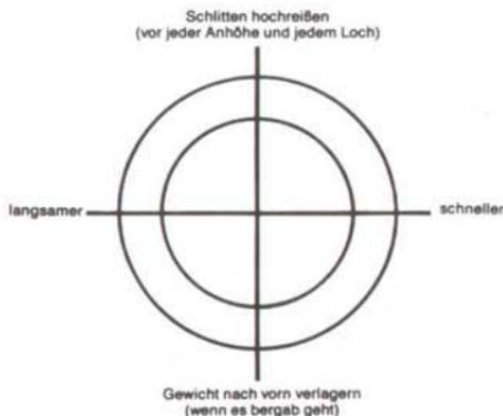
Es ist wichtig, daß auf jeder geraden Ebene keine Gewichtsverlagerung stattfinden darf (der Joystick muß in Mittelstellung gebracht werden), da der Schlitten sonst das Gleichgewicht verliert.
