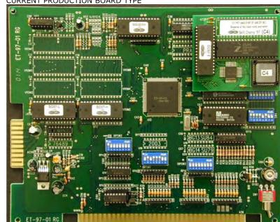
JUMPER 12 POSITION: UNDERNEATH DIP SWITCH 1, CLOSE TO EDGE. MARK J12.
